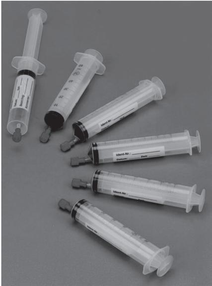
Bild 4. Spritzenbasett zur Messung des Luftwechsels bestehend aus einer mit SF<sub>6</sub> gefüllten Injektionsspritze (links) und fünf leeren Spritzen zur Probenahme. Bild: TracerTech
