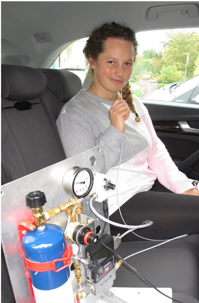
**Bild 1.** Mitfahrerin in einem Pkw mit Injektionsschlauch vor dem Mund und Injektionsapparatur im Vordergrund. Bild: Fa. TracerTech
