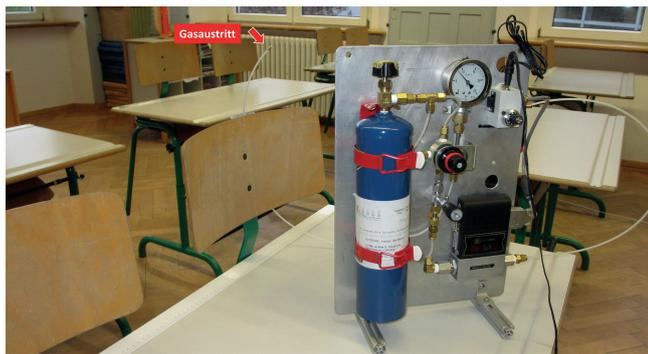
Bild 10. Tracergasinjektionseinrichtung mit PDCB-Tracer zur Modellierung der Emission eines infizierten Schülers. Bild: Fa. Tracer Tech
